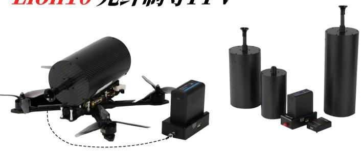
光纤制导FPV具有高速、稳定和低延迟的信号传输特点,更加精准的接收指令和传输数据, 能够大大降低信号受到干扰的可能性,提高穿越机的飞行安全性和可靠性。
